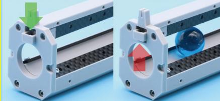
下段の2本のステーがレールに。上段の1本のステーがビー玉を強制的にレールに押し付けることで、弾速はやや落ちるが弾道が安定する。
